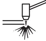
Pour couper un matériau d'une épaisseur allant jusqu'à 10 mm (3/8 po), amorcer la torche à l'extrémité de la pièce à couper afin de prolonger la durée de vie des consommables.
